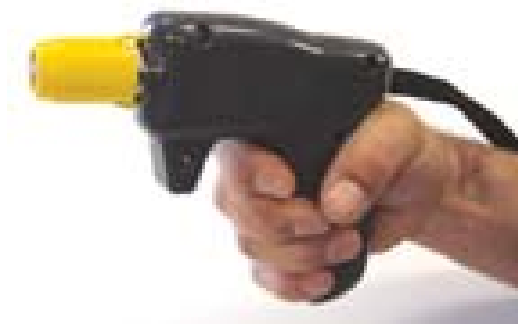
在开始使用手用注射枪之前，先排除手用注射枪和连接软管中的所有空气。
