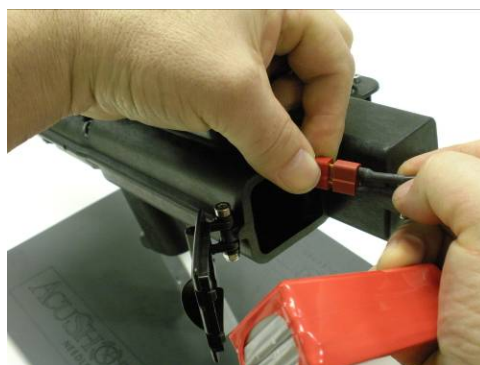
将电池插头插入注射器插口
