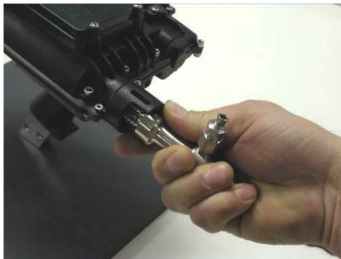
将注射管口转动到螺纹的末端
