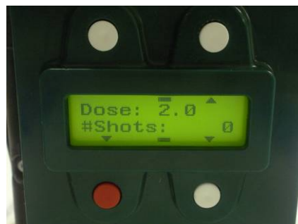
10. 注射器注射设置完成后，屏幕将显示 1. 注射剂量， 2. 注射次数，（如图所示：注射剂量为 2.0cc；注射次数为零（0））
