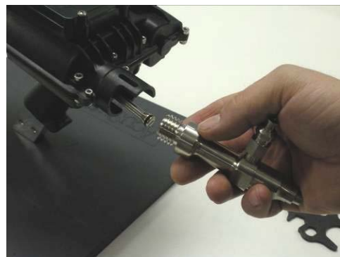
拔出注射管口并取出注射活塞
