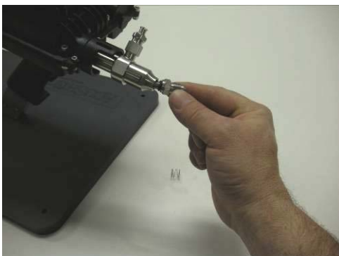
安装手用注射枪连接软管的连接器在注射器管口端部
