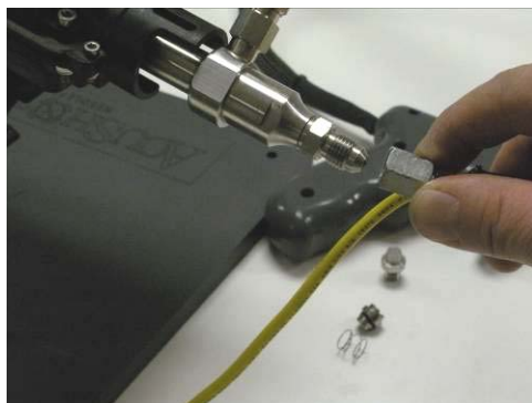
安装连接软管
