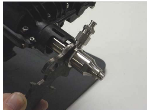
用板钳松动注射管口端部
